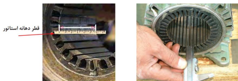
شکل پ- ۵۱ اندازه‌گیری طول و قطر داخلی استاتور
