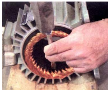
شکل پ- ۴۷ نحوه استفاده از قلم جهت قطع سیم‌پیچی‌ها
