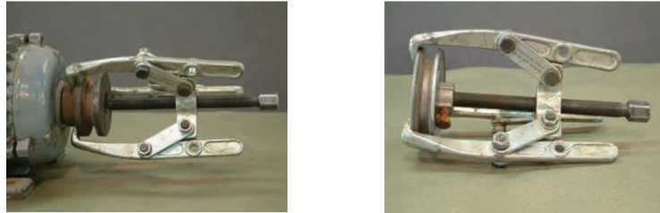
شکل پ- ۴۴ جدانمودن پولی از محور موتور
