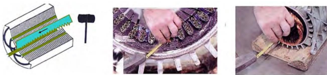
شکل پ- ۴۸ خارج نمودن سیم‌پیچی‌ها از داخل شیار
