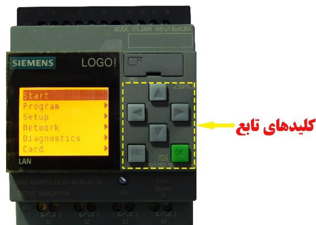
شکل پ- ۱۸ مشخص کردن کلیدهای تابع بر روی Logo 230 RC
