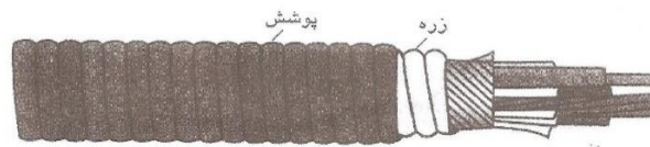
شکل ۷-۵ زره و پوشش کابل
