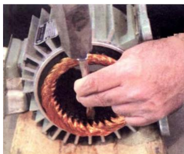
شکل پ- ۱۵ نحوه استفاده از قلم جهت قطع سیم‌پیچی‌ها
