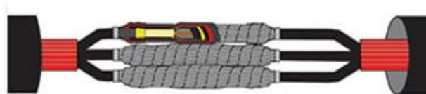
شکل ۱-۱۱ مفصل حرارتی (الف) برای کابل تک کور؛ (ب) برای کابل ۳ کور
