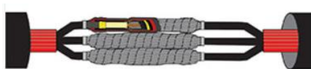
شکل ۱-۵ مفصل حرارتی (الف) برای کابل تک کور؛ (ب) برای کابل ۳ کور
