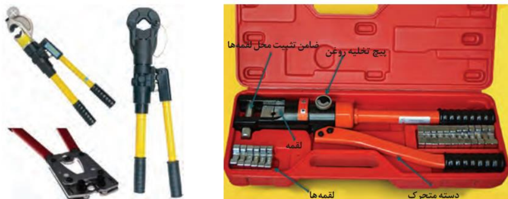
شکل ۴-۶ دستگاه کابلشو هیدرولیکی و دستی
